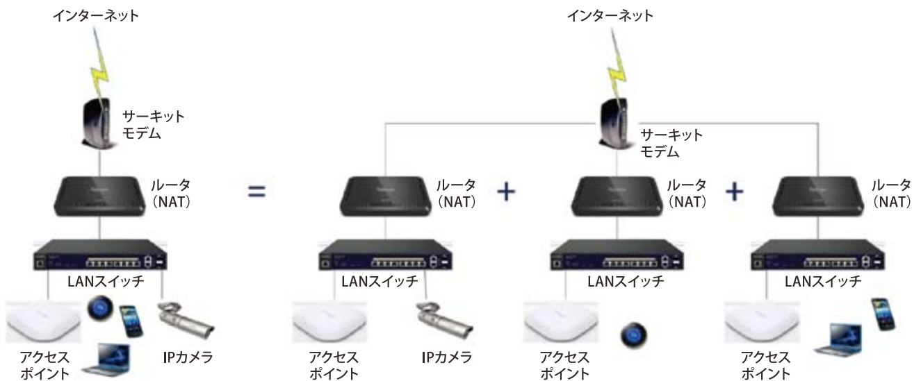
図2：仮想ローカルエリアネットワーク (VLAN) の概念。1セットのハードウェアは、それぞれ独自の使用要件のセットによって複数の並列仮想ネットワークを作成するために使用します。 3
