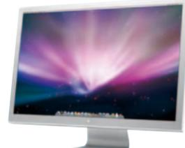
「Apple Cinema HD Display」は、アルミニウム製の筐体に23インチ(対角表示領域)のアクティブマトリクス液晶ディスプレイを搭載。解像度は1,920×1,200ピクセルで、高解像度の画像や動画の表示に適している。ワイドフォーマット設計を採用し、2ページ分の等倍テキストやグラフィックスを一度に表示。スクロールやウィンドウを切り替える手間が省ける。DVIコネクタ対応で、Windows PCとの接続も可能だ。
