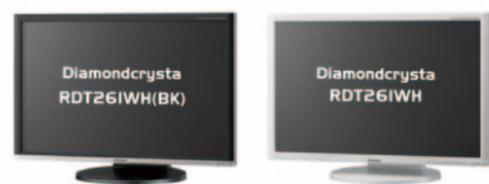
「RDT261/WH」は業界初の25.5型H-IPS方式WUXGA対応ワイド液晶パネルを搭載。コントラスト比750:1、中間階調間応答速度7.5ms、広色域域NTSC比約92%といった特徴によって、AdobeRGBの映像データが持つ本来の色をほぼ再現できる。角度や高さが自由に換えられるダブルヒンジスタンドを採用し、作業内容に応じて調整可能だ。HDCPに対応した「DVI-I」「DVI-D」端子を備え、デジタル・アナログとの3系統入力に対応している。
