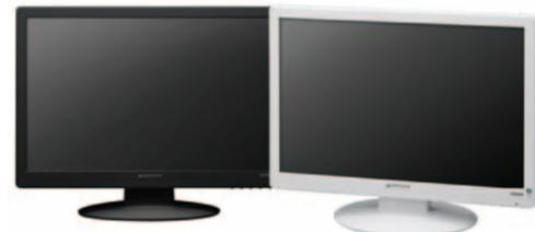
WSXGA+(1,680×1,050)の高解像度表示に対応しているため、広い作業領域、高画質な再現性を確保できる。たとえば複数のウィンドウを並べて表示したり、表計算ソフトをスクロールすることなく幅広く表示する。またワイド解像度のDVDを楽しむ、高画質の画像データの編集/閲覧が可能など、高画質な閲覧環境を提供する。コントラスト拡張機能をon時には3000:1への画像切り替えと、アスペクト比16:10と4:3の切り替えが可能。
