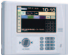
アマノのタイムレコーダー「AGX-350」。FelicaなどのICカードに対応した入室管理システムだ
