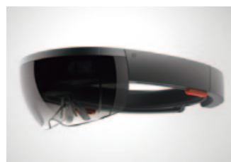
マイクロソフトが開発中の「HoloLens」。内部にCPUやGPUなどが搭載されており、他のデバイスとの接続が不要で、単体で動作する
