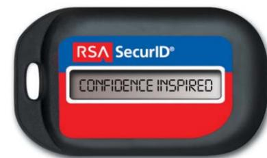
「ワンタイムパスワード」は、RSAの「SecureID」のように、自動的にパスワードを生成する「トークン」と呼ばれる機器により、アクセスする度に、新しいパスワードを使うことで、セキュリティを高める認証方式
