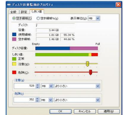
サーバのディスク容量を監視するための諸設定を行う監視画面
