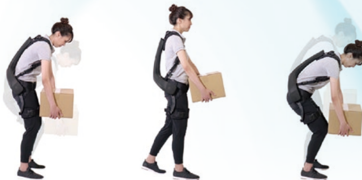
「持ち上げ」「歩行」「持ち下ろし」の各動作に自動対応することもATOUN MODEL Yの特長
