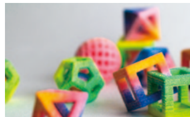
3D Systems社から発売予定の3Dプリンター「ChefJet」による砂糖細工の出力例。
