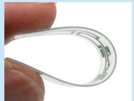
富士通フロンテックが開発した洗濯対応のUHF帯RFIDファッションタグ。透明素材で作られており、超薄型なのでレースやシルク素材などにも縫い付けて使える。
