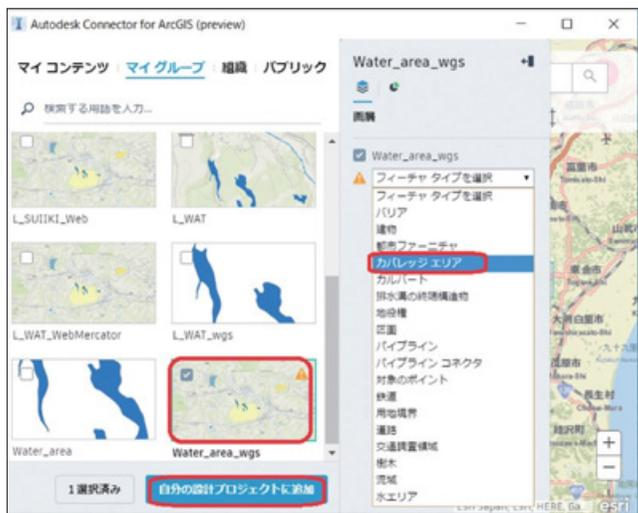
図4. InfraWorksにArcGIS OnlineのGISデータを直接取り込むことができる。
