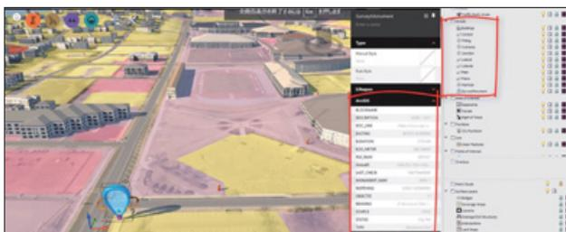
図6. ArcGIS Onlineの画層や属性をモデルエクスプローラやプロパティで表示(現時点ではフィーチャー サービス「ポイント・ライン・ポリゴン」として共有されているデータを利用できる)。
