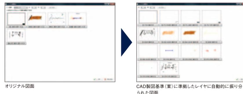
オリジナル図面 → CAD製図基準(案)に準拠したレイヤに自動的に振り分けられた図面
