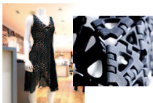
3,000個超のパーツを5,000個近いヒンジでつなげたナイロン製のワンピース。3Dプリンターで出力されたドレスは、折りたたまれた状態で出力される。
