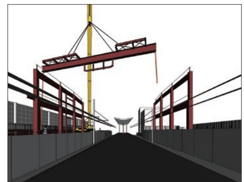
ホーム上から見た鉄骨建方の状況をBIMにより事前確認した
