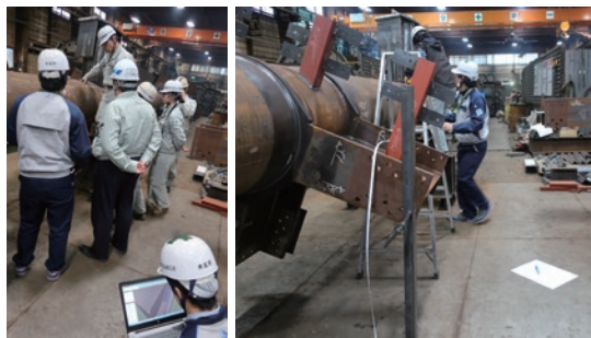
ノート型ワークステーションでBIMモデル上の寸法を測定し(左)、でき上がった鉄骨部材を実測する(右)
