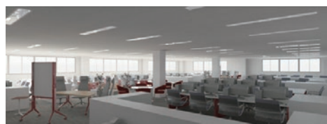
昼間の太陽光だけで執務室内の明るさ分布をレンダリングにより求めた例
