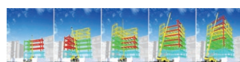
BIMによる施工シミュレーションの例。資材置き場やクレーンの位置、鉄骨の建て方などのステップをアニメーション化し、情報共有を図った。
