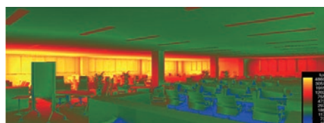
上図の執務室における照度分布を日射解析により求めた例。見た目だけでなく、エンジニアリング的な数値も求めて検討を行っている
