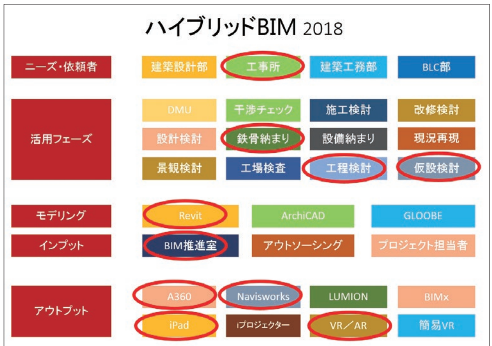
ハイブリッドBIMのメニュー。活用フェーズにおける課題、モデリングソフト、アウトプットの形式などを、初期段階で具体的にイメージできるようにしている
