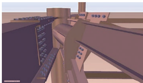
鉄骨の施工BIMモデルをVRで見ながら溶接が可能かどうかを検討
