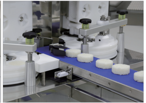
おにぎりを製造する不二精機の小型成形機。1 時間に最大 7000 個製造する能力を持ち、コンビニエンスチェーンの食品工場などで利用されている。
