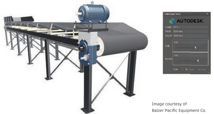
Autodesk InventorのiLogicで作られたコンベヤコンフィギュレーター
