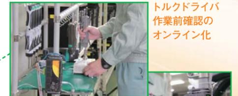
トルクドライバ作業前確認のオンライン化
